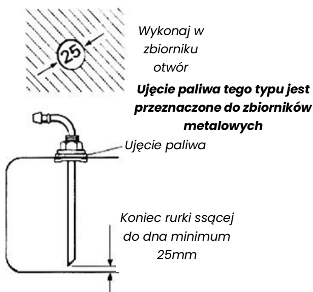
Rysunek 10 – Sposób montażu ujęcia paliwa w zbiorniku
