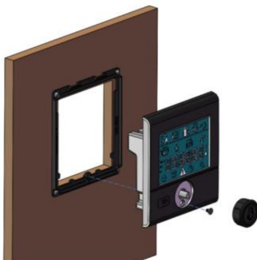
Rysunek 8 – Montaż sterownika LCD
